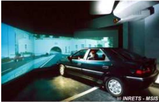
Figure 2 Simulateur SIM<sup>2</sup> à base fixe
